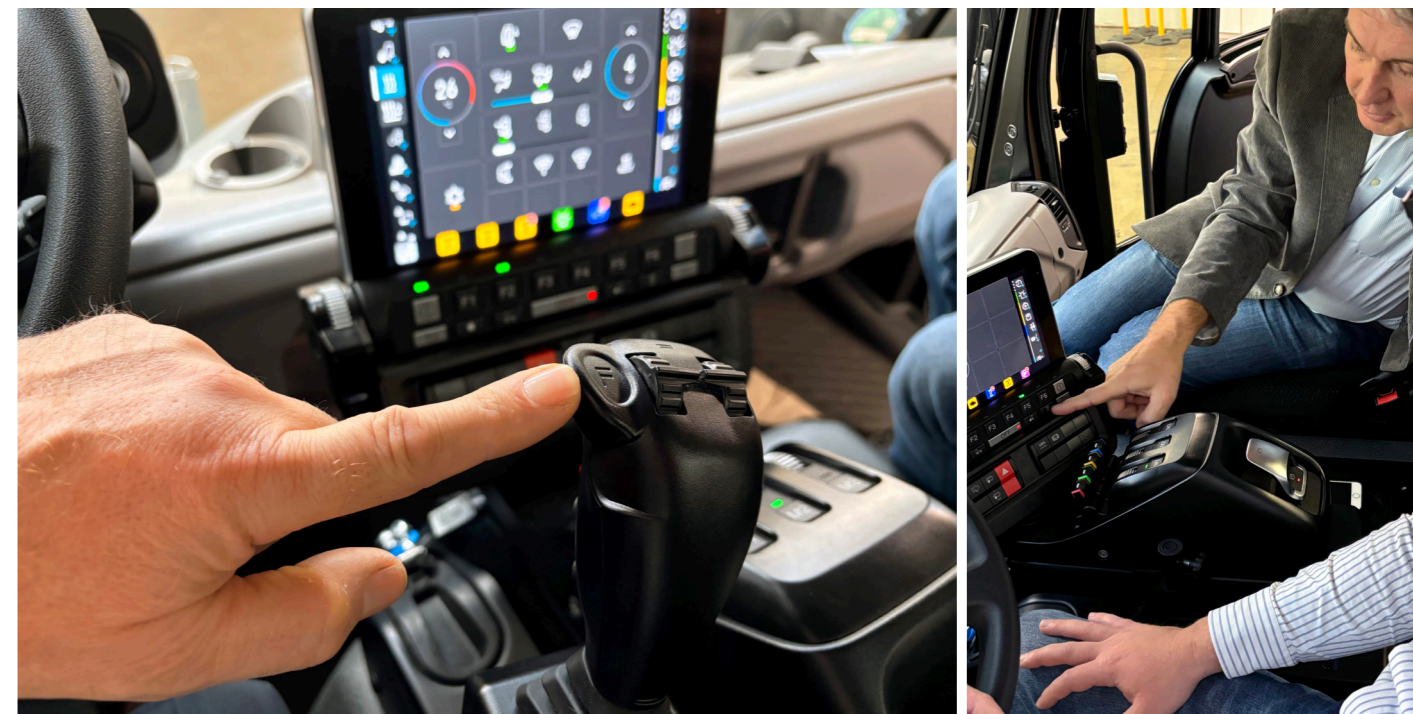
UNI-TOUCH系统一览：中控台由触摸屏、附加的模拟式按钮、各种拨动开关和RAFI LINEAR JOYSCAPE组成。
