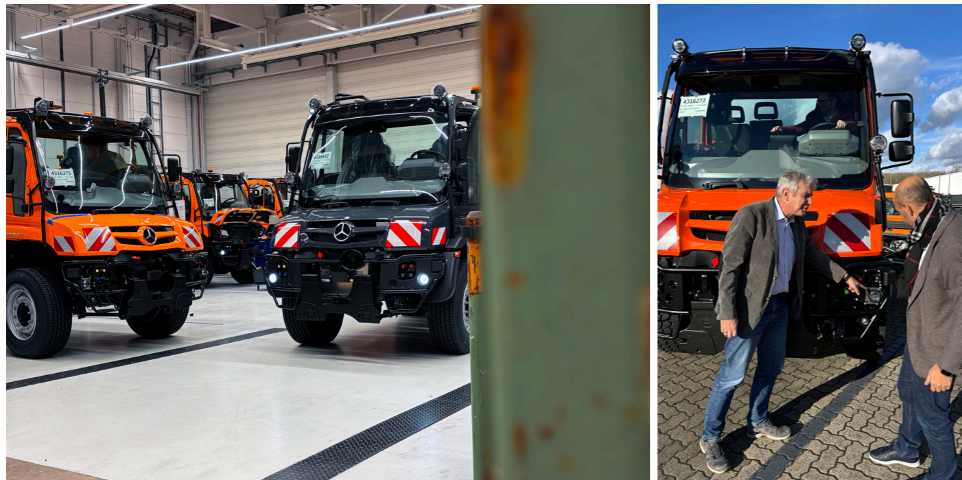
新旧两代间的细微差别：前代车型每侧有三个灯，而现在每侧各一个灯，昭示“我是一辆UNI-TOUCH”。
