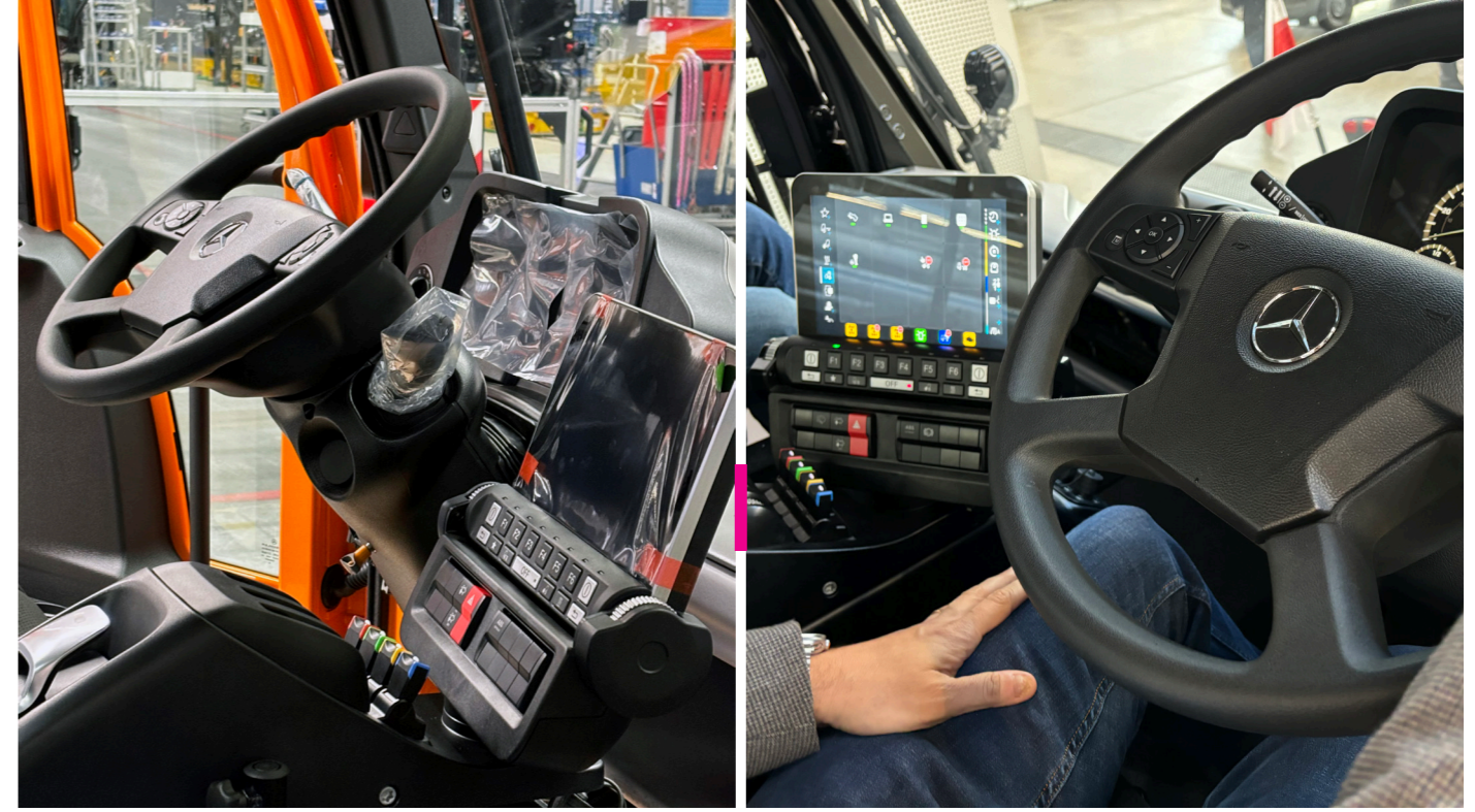
最大程度的驾驶自由：作为标准配置，方向盘安装在左边的驾驶侧，可通过滑动装置移向右侧。
