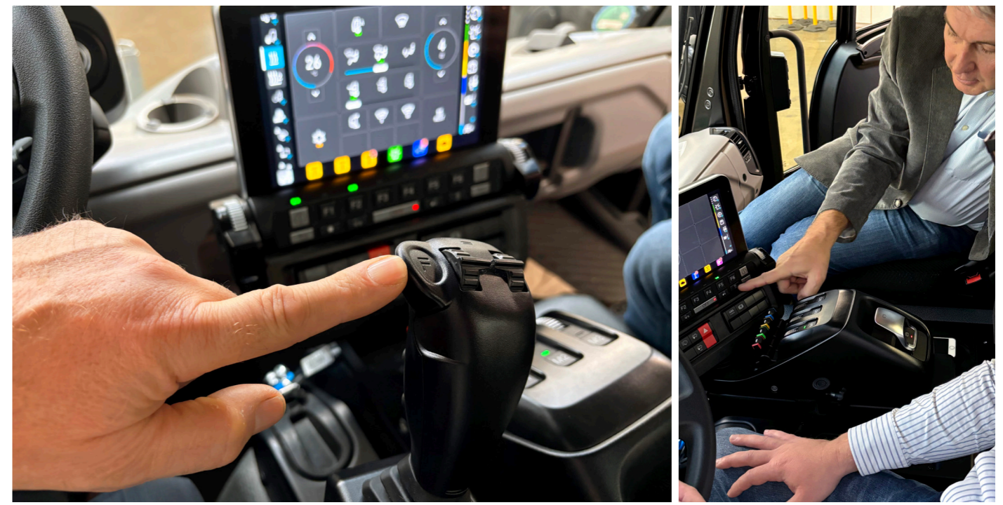
El sistema UNI-TOUCH de un vistazo: la consola central consta de una pantalla táctil con pulsadores analógicos adicionales, varios interruptores basculantes y el RAFI LINEAR JOYSCAPE.
