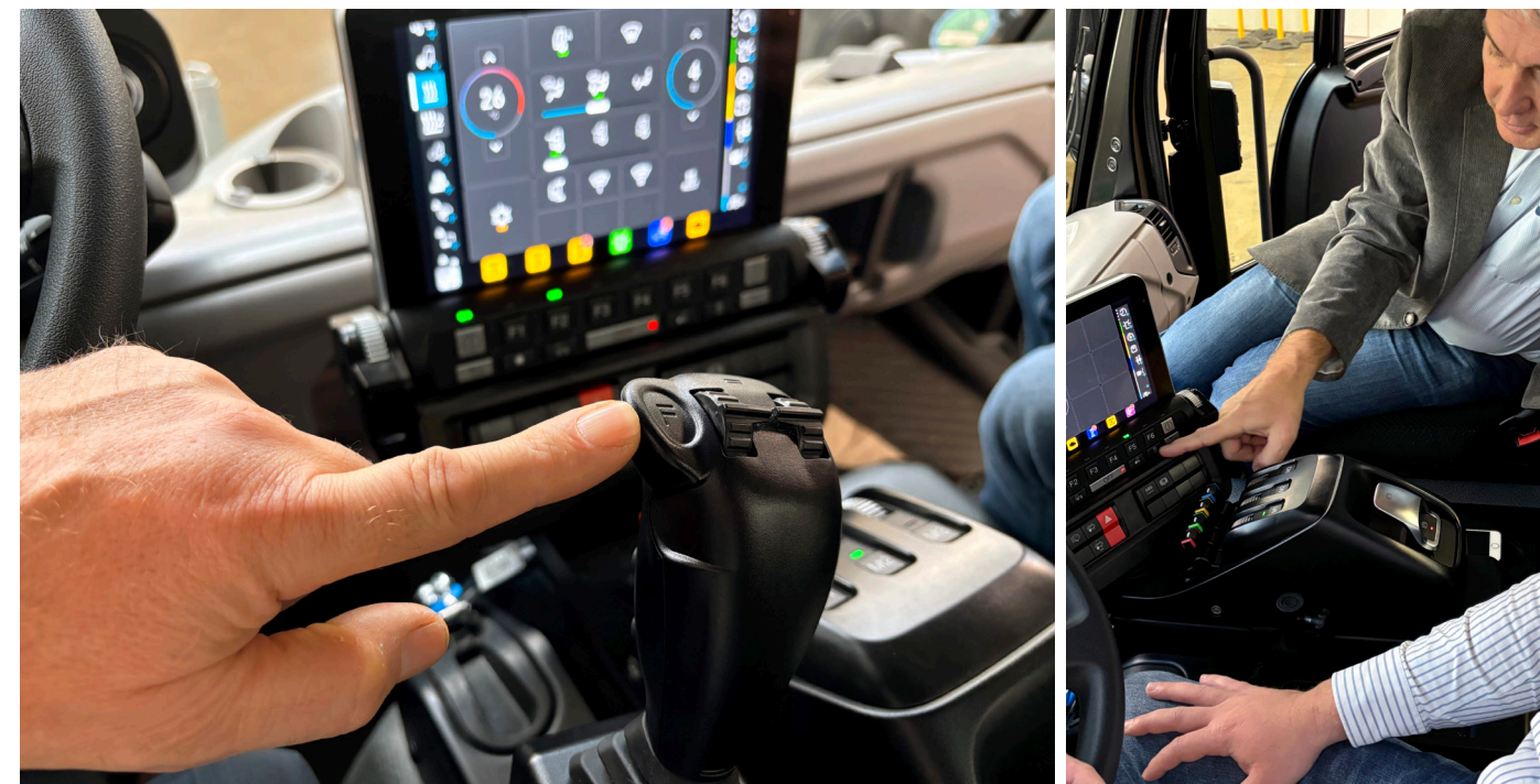
Le système UNI-TOUCH en un coup d'œil : la console centrale se compose d'un écran tactile avec des touches analogiques supplémentaires, de divers interrupteurs à bascule et du RAFI LINEAR JOYSCAPE.
