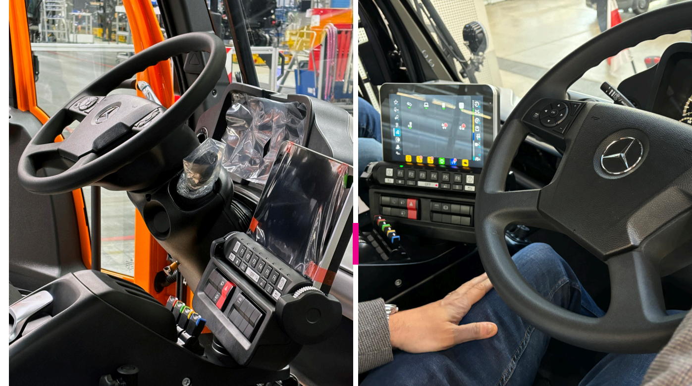
Liberté de conduite maximale : installé en standard du côté gauche du conducteur, le volant peut être déplacé vers la droite grâce à un dispositif coulissant.
