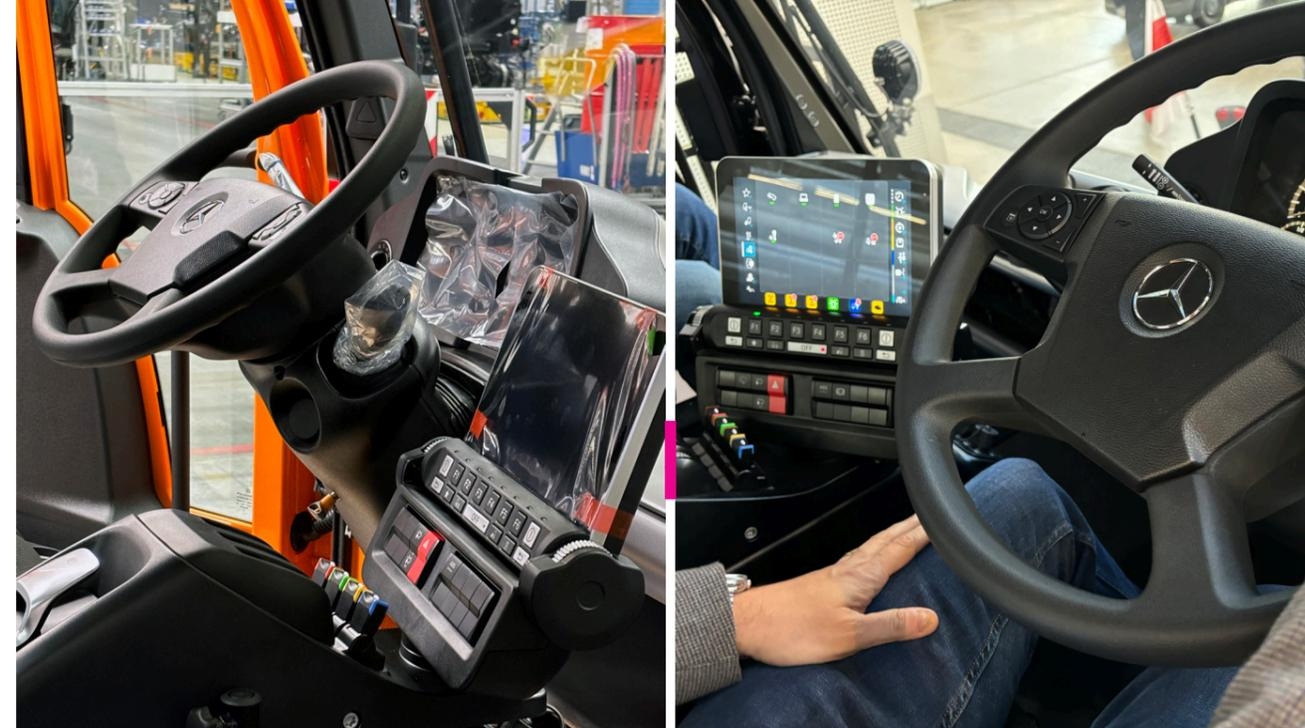
Massima libertà di guida: montato di serie sul lato sinistro del guidatore, il volante può essere spostato a destra grazie allo sterzo variabile.
